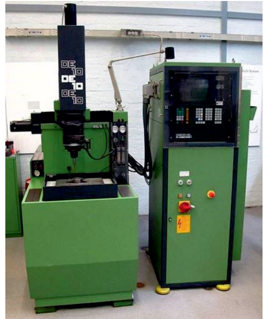
[Bild 1] EDM aus den 80er Jahren, ohne Schürze. Das CO 2 kann, weil schwerer als Luft, über den Beckenrand abfließen.
