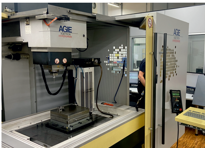
[Bild 2] EDM im Stadium der Werkzeugeinbringung, EDM offen
