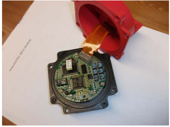
Elektronische Antriebseinheit eines CNC-Automaten
