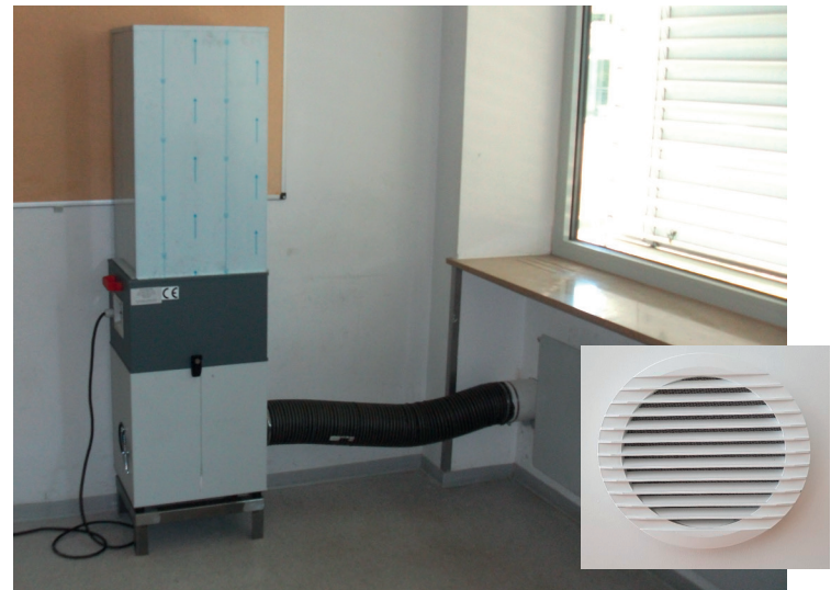
Versuchsanordnung im Klassenzimmer: Luft entweicht über die Fensterfugen. Bilder zeigen die Ansichten von innen (links), sowie die Außenansicht (rechts).
