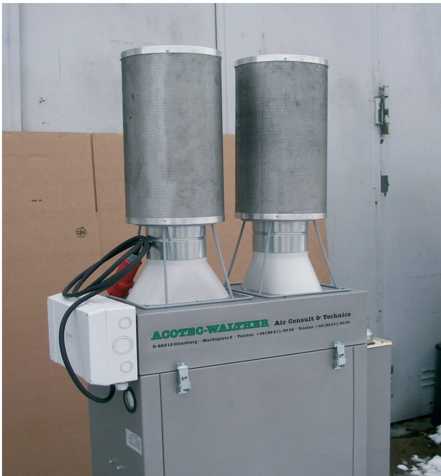
Bild 4: Aktivkohlefilter als 3. Filterstufe, nach dem Ventilator
